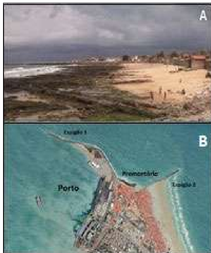
Figura 2. (A) Ponta do Mucuripe, que representa um promontório rebaixado situado no segmento NE da cidade de Fortaleza, é uma feição natural que muda a orientação da linha de costa, de SE-NW para NE-SW. (B) O Porto do Mucuripe, instalado nos anos 1950, conta com dois espigões costeiros que foram construídos para proteger a baía portuária do ataque das ondas e do assoreamento. Os espigões interromperam a deriva litorânea, que se desloca para oeste.
