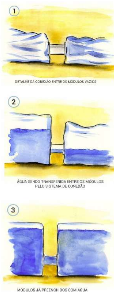
Figura 4. Detalhe do funcionamento do sistema - 1: Vazio, 2: Sendo preenchido por água e 3: Totalmente cheio. Fonte: Melo, 2019.
