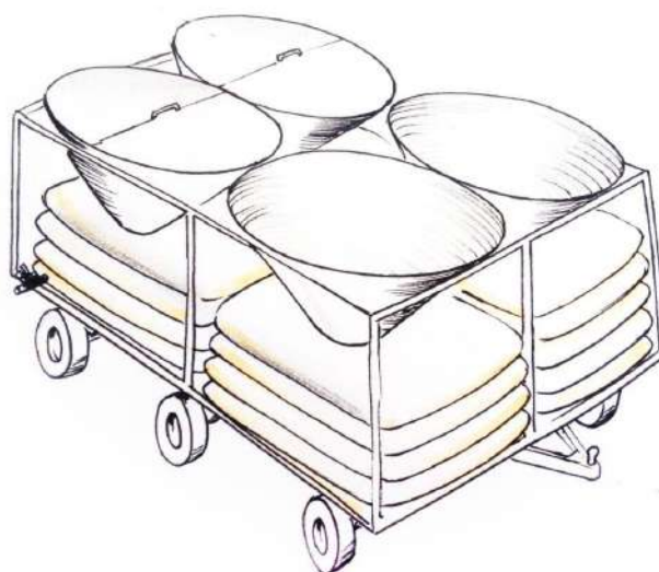
Figura 9. Sistema com módulos para armazenamento de água da chuva. Fonte: Autores
