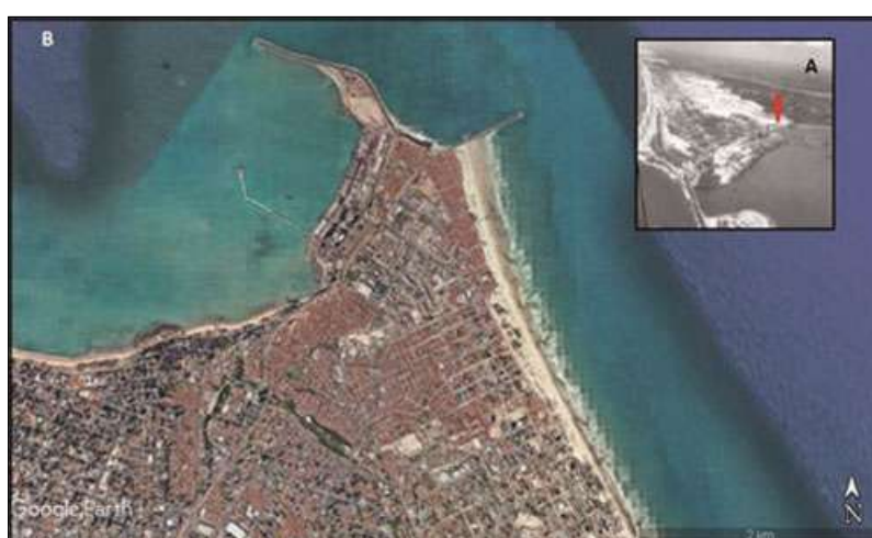
Figura 5. (A). Costa leste de Fortaleza e entorno do Porto do Mucuripe, com largos campos de dunas. A seta vermelha indica a área onde o by-pass de dunas ainda ocorreria logo depois da construção do porto. (B). Completa urbanização do campo de dunas, o que resultou na interrupção do bypass de areias para o segmento norte do litoral de Fortaleza.
