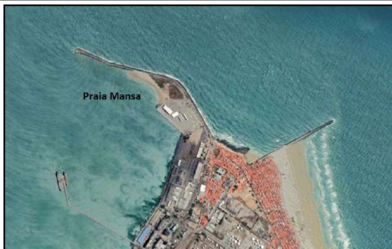
Figura 3. O bypass residual de areia através dos espigões costeiros e do promontório resultaram na formação da Praia Mansa, e continua alimentando esse segmento costeiro regularmente. O bypass também produz assoreamento na bacia portuária, a qual precisa ser dragada com frequência (Imagem Google Earth, 2019).
